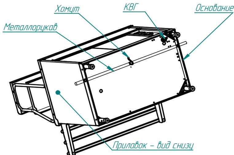
В основаниях изделий линии раздачи введено сквозное отверстие диаметром 29,5 мм и поддерживающие хомуты для возможности проведения металлорукава с питающими кабелями сквозь все изделия линии раздачи.
